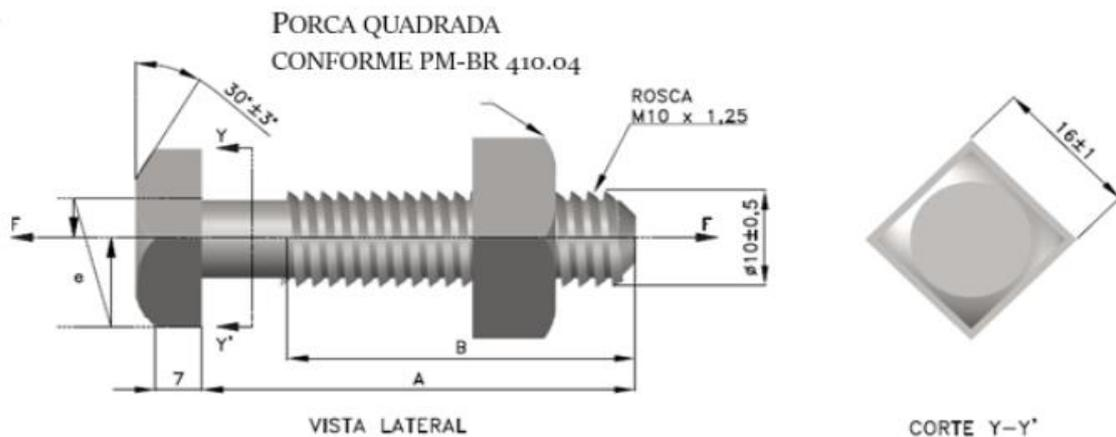
**Figura 1** - Parafuso Cabeça Quadrada M10
